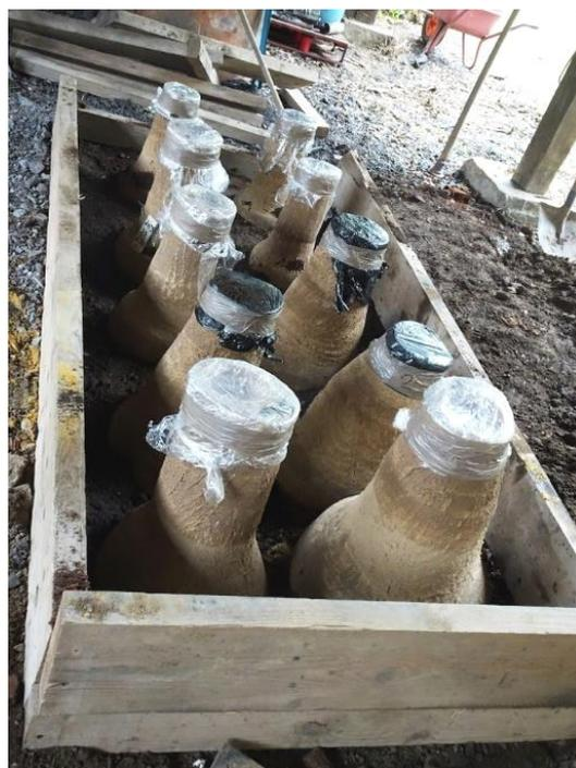
*Moules de cloches prêts à être enterrés en vue de la coulée*
