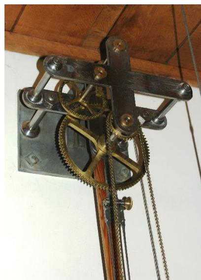
*Balancier et échappement fixés sous le plafond*
